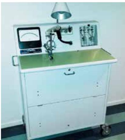
Рис. 4. Один из первых анализаторов газов крови МикроАструп (AME1) 1959 г. компании «Radiometer» (Дания)
