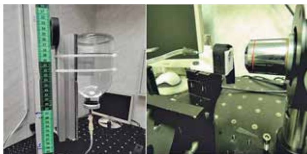
Рис. 2. Вид капельницы на штативе для установки ВГД (слева) и вид держателя глазного яблока с глазом и иглой от капельницы в ходе эксперимента (справа)
