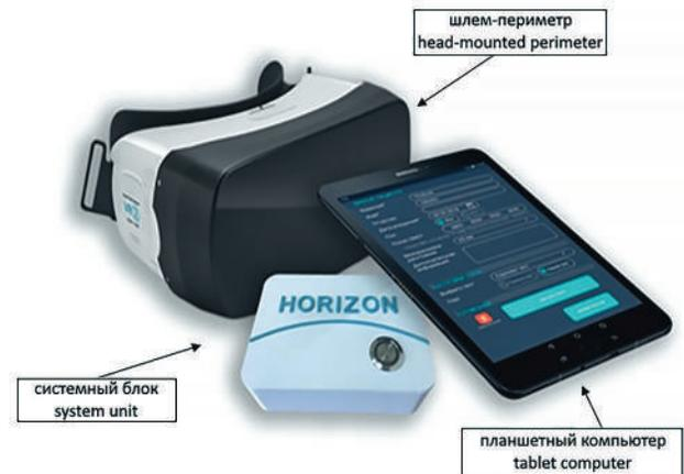
Рис. 1. Портативный периметр на основе устройства виртуальной реальности.
