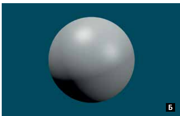
Рис. 7. Построение шара: А — из малого количества полигонов; Б — с применением механизма «сглаживания»
