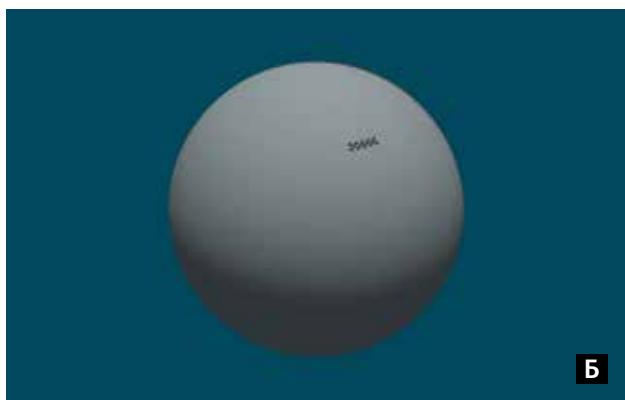
Рис. 6. Построение шара из различного числа полигонов, обозначенных черным цветом: А — из малого; Б — большого количества
