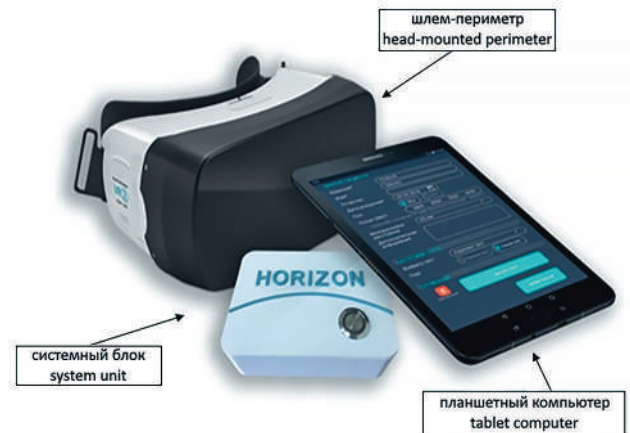
Рис. 1. Портативный периметр на основе устройства виртуальной реальности.
